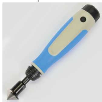
Инструмент для снятия грата NG3100 с зенкер-насадкой 90 (C20) и телескопическим держателем C, Ø отверстия 3 - 20 мм
